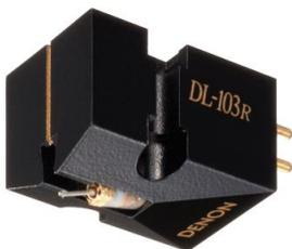
Testina Moving Coil (MC) di riferimento in rame 6N, con tensione di uscita 0.25 mV, risposta in frequenza 20Hz - 45KHz, impedenza di uscita 14 Ohm, peso 8.5g.
